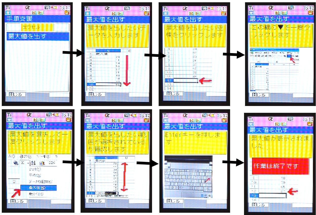
図2 作業手順表示機能における携帯電話画面の一例（エクセルで最大値を出す，写真を表示し，音声や動画で説明することが可能である）
