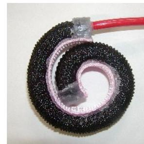
図 2 湾曲型空気圧ゴム人工筋
