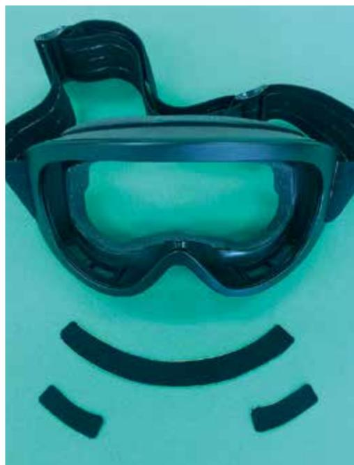
② 遮光用シート材を通気孔の形状に合わせて切り出す
