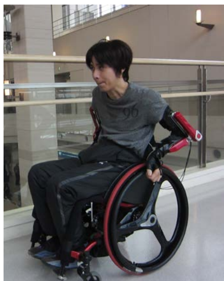
図1 上肢支援ロボットによる車いす操作支援
