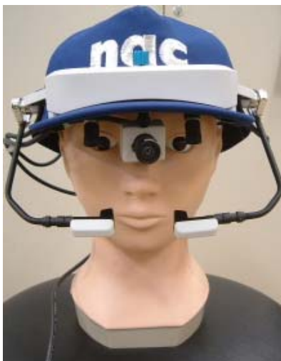
図5 視線検出装置 (株式会社ナックイメージテクノロジー製、 アイマークレコーダーEMR-8B)
