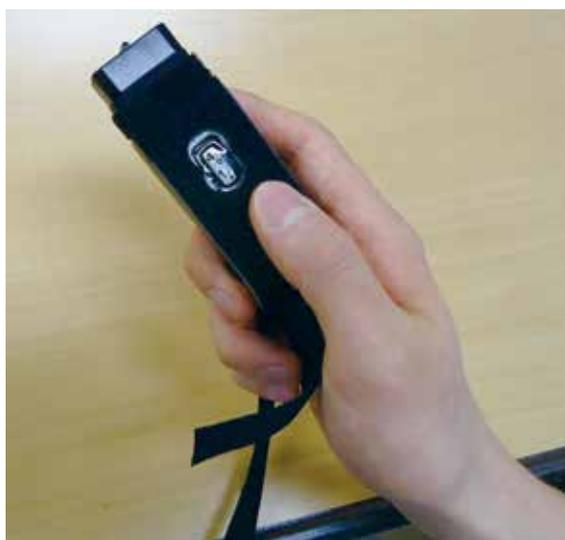
図 10 超音波式視覚障害者用歩行補助具の例<sup>35)</sup>
