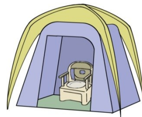
災害弱者用トイレを8町内会長で事前に組 み立て訓練。組み立て時間40分、置く場 所、照明、掃除用具の準備も必要。介護ト イレよりも安定性が良かった。カーテンの 開け閉めに介助が必要。(美原小)
