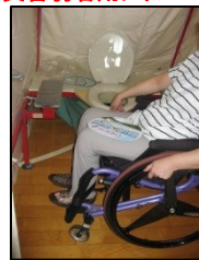
災害弱者用トイレを8町内会長で事前に組 み立て訓練。組み立て時間40分、置く場 所、照明、掃除用具の準備も必要。介護ト イレよりも安定性が良かった。カーテンの 開け閉めに介助が必要。(美原小)
