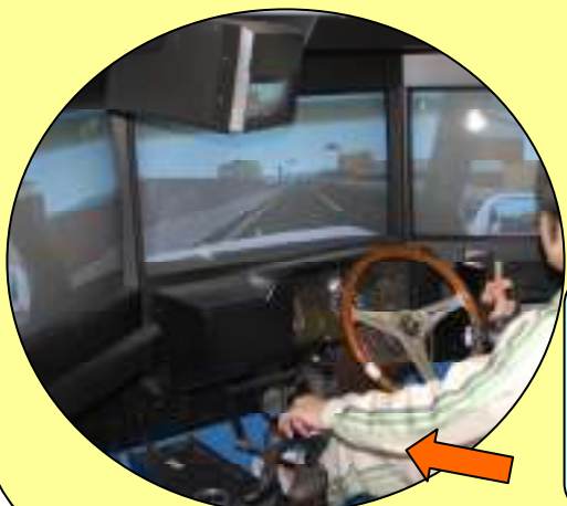
手動装置： 足の代わりに手でアクセル・ブレーキの操作が行なえます。
