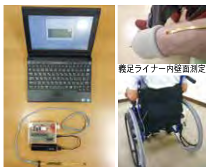
測定システム 義足ライナー内壁面測定 床ずれ防止マット測定 せん断力測定システム
