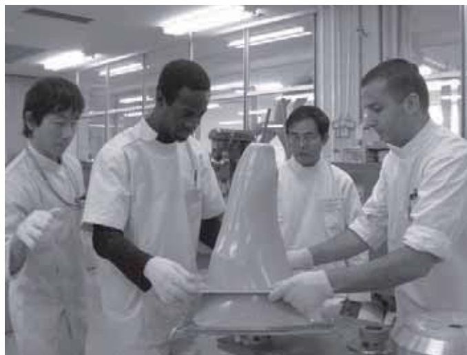
ソケットの製作を行っている様子
