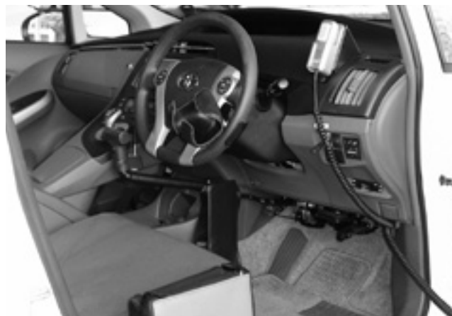
(写真4) 頸髄損傷者用の訓練車
