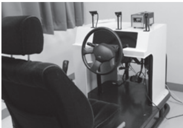
(写真1) アクセル、ブレーキ操作力検査
