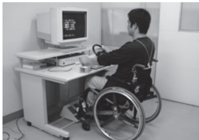
(写真2) CRT運転適性検査
