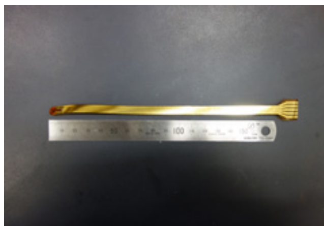
図4 独自開発したせん断力センサ（左側の丸い部分がセンサ、それ以外はリード線）
