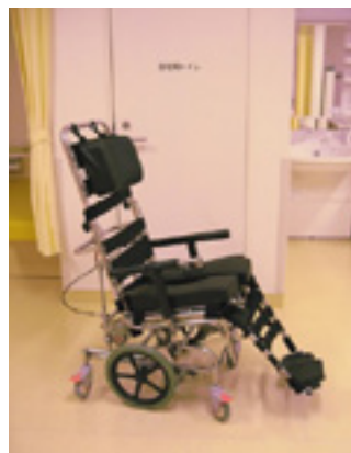
図2 試作した排泄用車いすの一例（チルト・リクライニング機構付）
