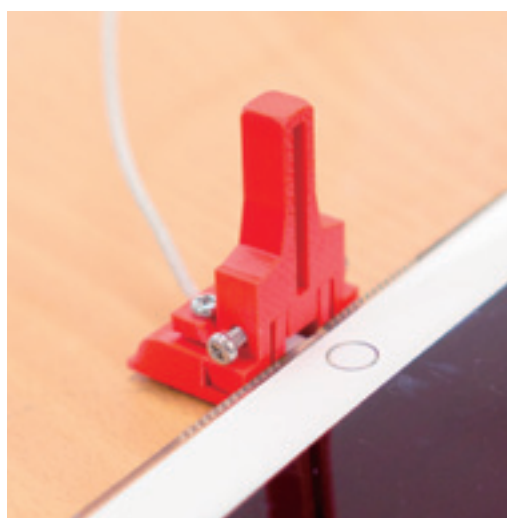
【充電ケーブル着脱用自助具（3Dプリンタを用いて製作）】
