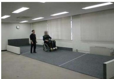
進行方向に対して横向きに傾斜のある路面では、車いすの進路が下り方向に流されてしまいます。この「片流れ」と呼ばれる挙動を、自動的に検知・補正する安全走行技術を開発しています。
