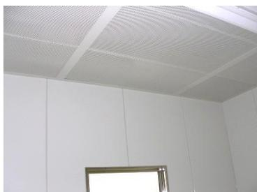
温度は-10 度から 42 度まで変化させることができる部屋で、温冷風を天井から吹出し、壁の下方で空気を吸います。
