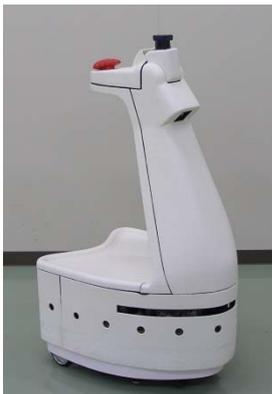
目の不自由な方が安心して歩けるロボット技術の実現を目指しています。今回は、使用者の行きたい方向に動き、障害物があると避けたり停まったりするロボットの試作機を展示します。
