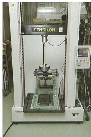
座位保持装置頭部支持部の後方静的荷重試験
