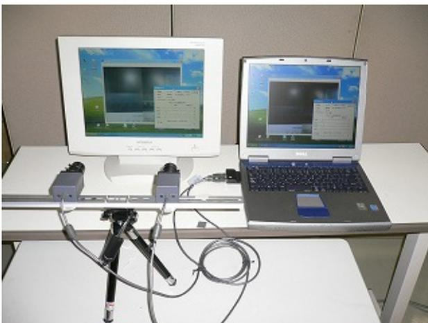
図8 レーザ光線利用によるダイレクトマウスポインティングシステム
