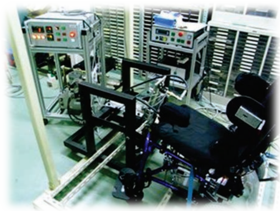
座位保持装置用耐荷重試験装置 (座位保持装置の認定基準)
