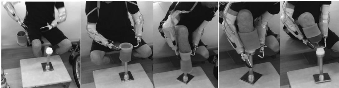
図 2 治具を用いたライナーの装着
