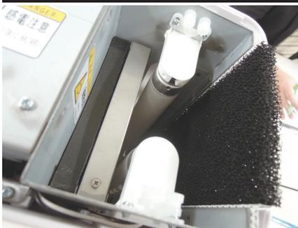
光触媒空気清浄機の内部。光触媒フィルター、UVランプ、吸引ファンで構成されている
